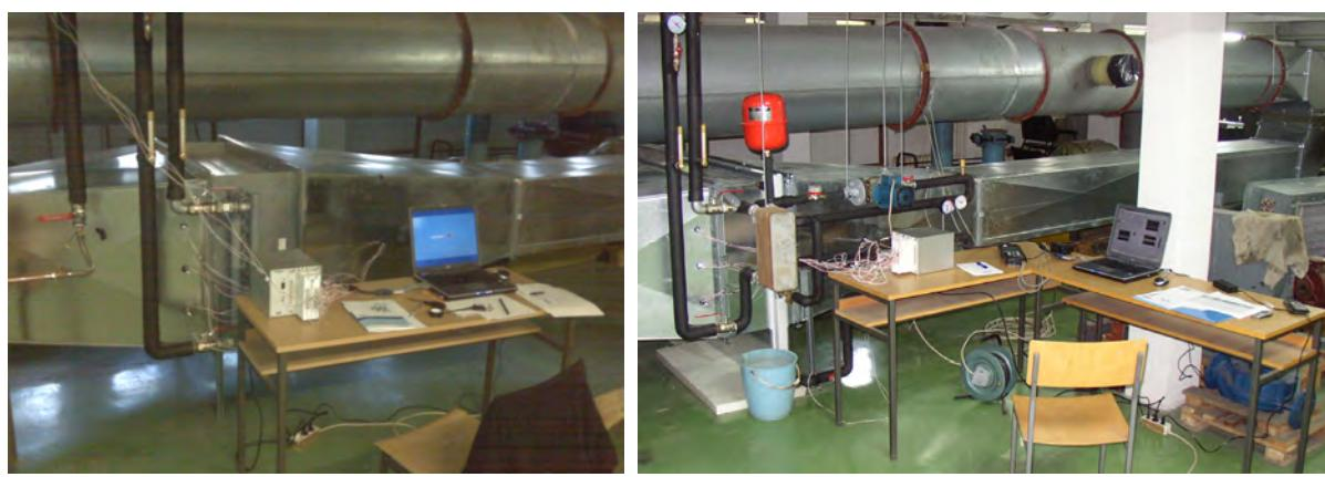
Slika 4.8. Ispitna zona s ugrađenim cijevnim lamelnim izmjenjivačem topline (a) i lamelnim izmjenjivačem topline s mikrokanalima (b)
