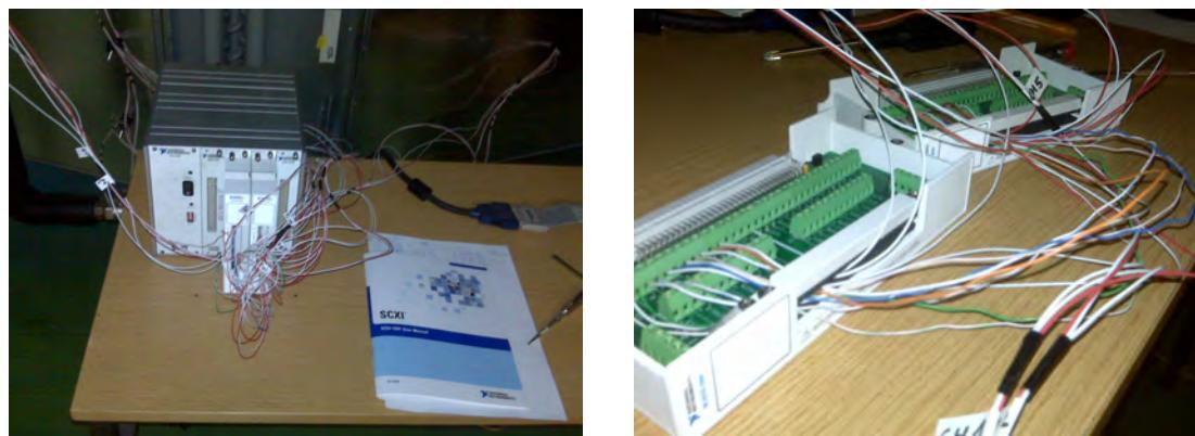
Slika 4.17. Sustav za akviziciju podataka (a), dva terminala SCXI 1300 (b)
