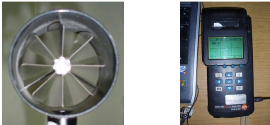
**Slika 4.13.** Prijenosni krilni anemometar (a) i *Testo 454*(b)
