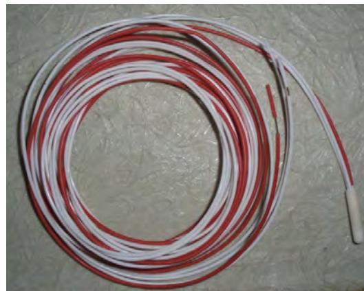
**Slika 4.9.** Platinasti otpornički termometar, Pt100
