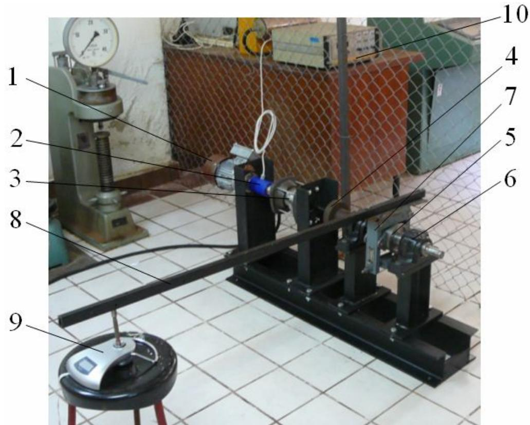
Sl. 5.7.3 Ispitni stol za dinamičko ispitivanje planetnih pretvarača; 1 – elektromotor; 2 – vratilo za mjerjenje momenta torzije; 3 – planetni pretvarač; 4 – zupčasta spojka; 5 – kočni bubanj ; 6 – ležaj; 7 – kočnica; 8 – poluga; 9 – dinamometar; 10 – tenziometrijska oprema.
