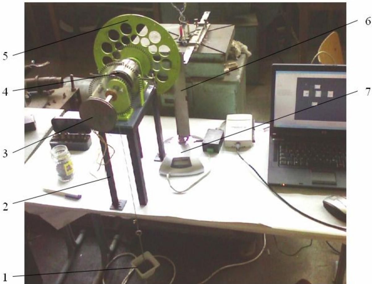
Sl. 5.6.3 Oprema za određivanje statičkog stupnja iskoristivosti; 1 – uteg; 2 – nosač pretvarača; 3 – remenica na ulaznom vratilu pretvarača; 4 – pretvarač; 5 – disk na izlaznom vratilu pretvarača; 6 – element za prenošenje sile s diska na dinamometar; 7 – digitalni dinamometar.
